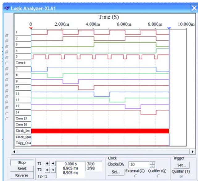
Рис. 15. Результаты тестирования дешифратора трехразрядного двоичного кода
